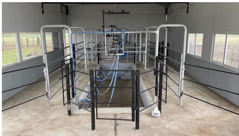
Figura 1. Sistema de ordeño de 4 bajadas instalada en la planta piloto. EQUQLAC, Villa María, Córdoba, Argentina
